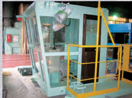
天井クレーン運転室
