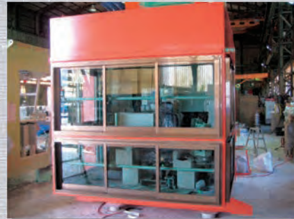
コンテナクレーン運転室
