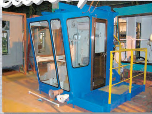
天井クレーン運転室
