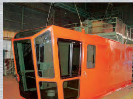
ジブクライミングクレーン運転室
