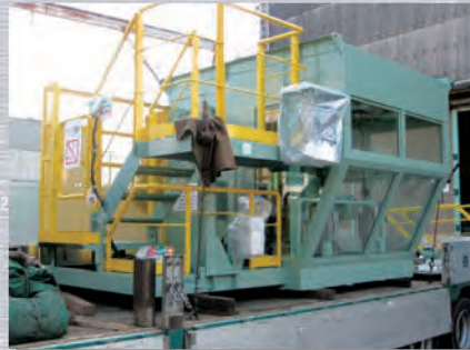
レールクレーン運転室
